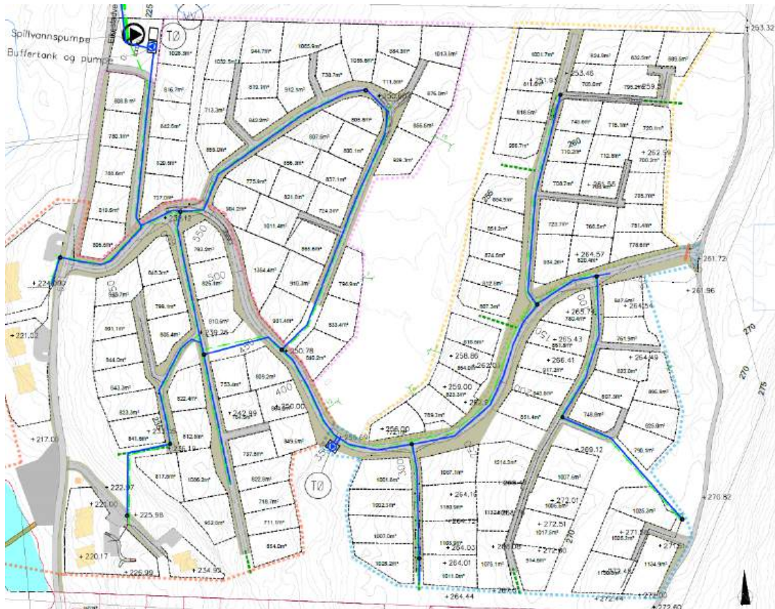
Figur 2: Utklipp fra tegning 01 Ledningsplan
