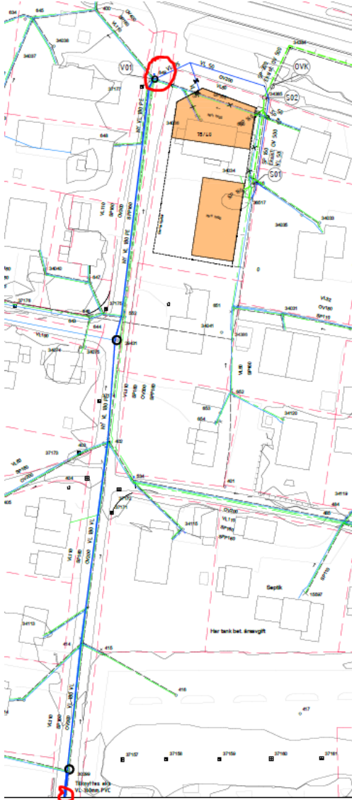
Figur 5: Utklipp ledningsplan for oversikt over ny vannledning.
