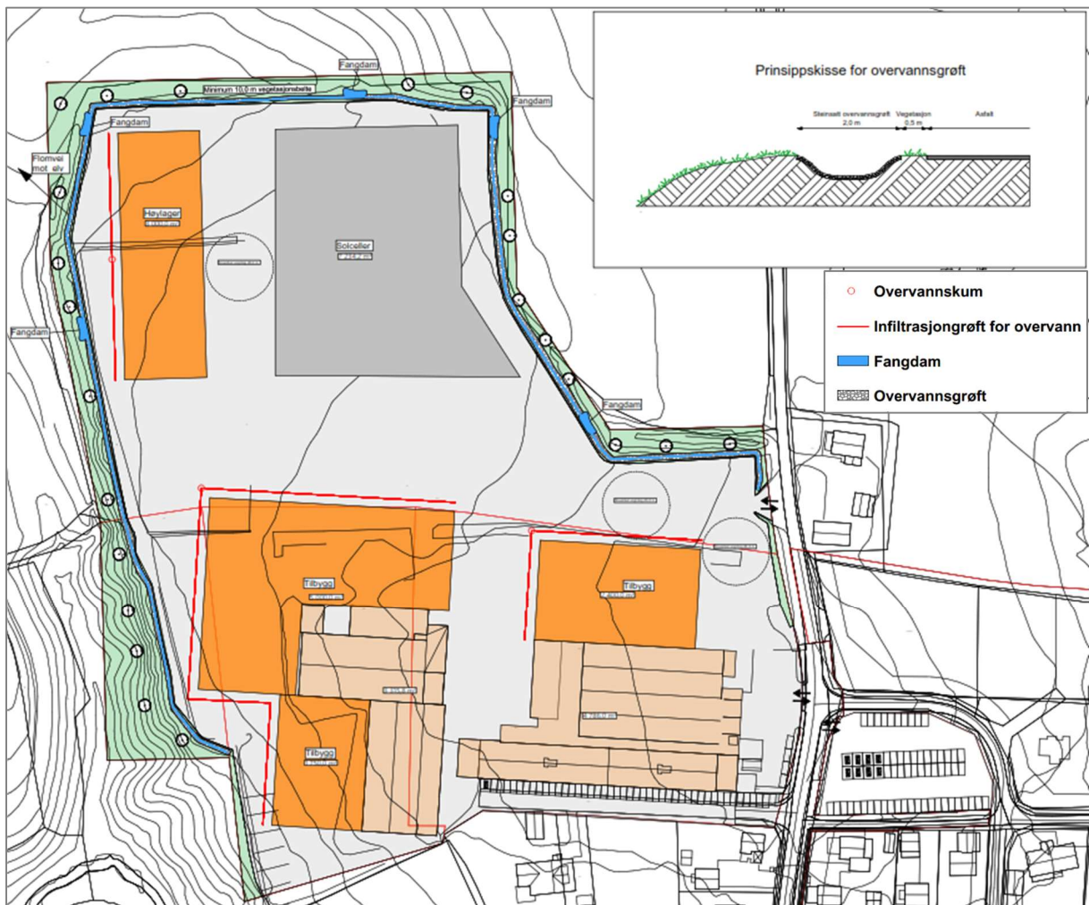
Figur 10 Viser prinsippskisse overvann i sin helhet
