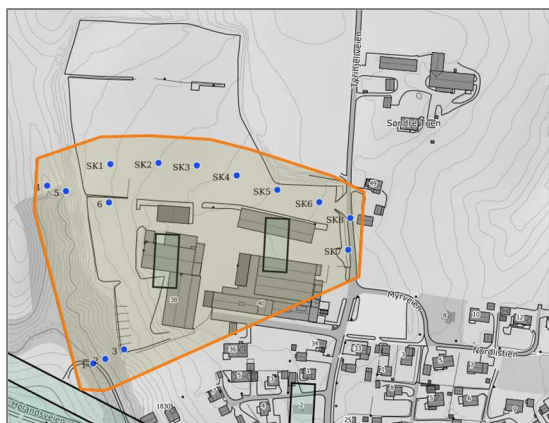
Figur 3 I 2002 ble det gjennomført grunnundersøkelser, markert med et oransje omriss og borepunkter markert i blått.
