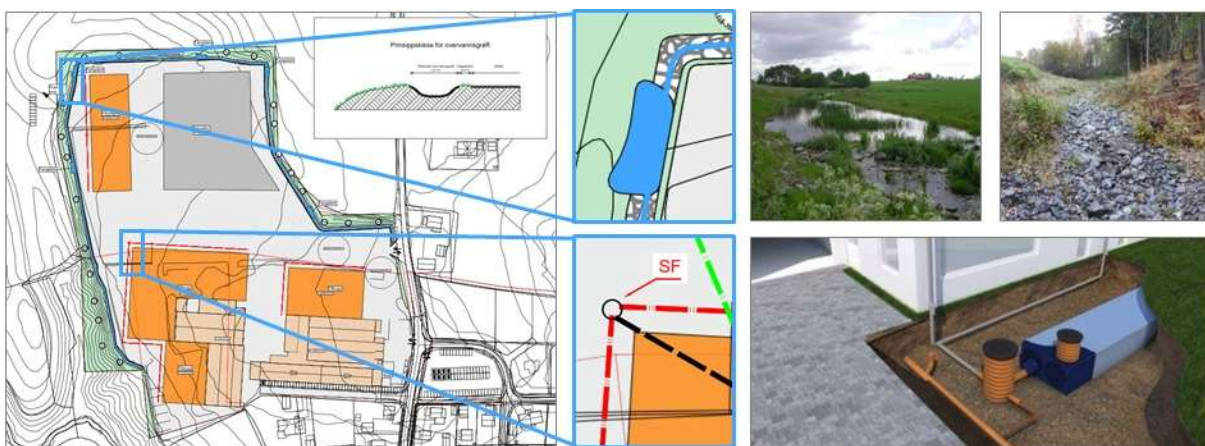
Figur 8 Prinsippkisse overvannshåndtering. Eksempler på åpne overgangsløsninger i randsonen fangdam & overvannsgroft. Takvann kan også håndteres i lukkede løsninger lokalt (OV-rør), før det ledes til vassdrag, men det skal bestrebes minst mulig bruk av rør, mest mulig bruk av åpne grøfter/renner.
