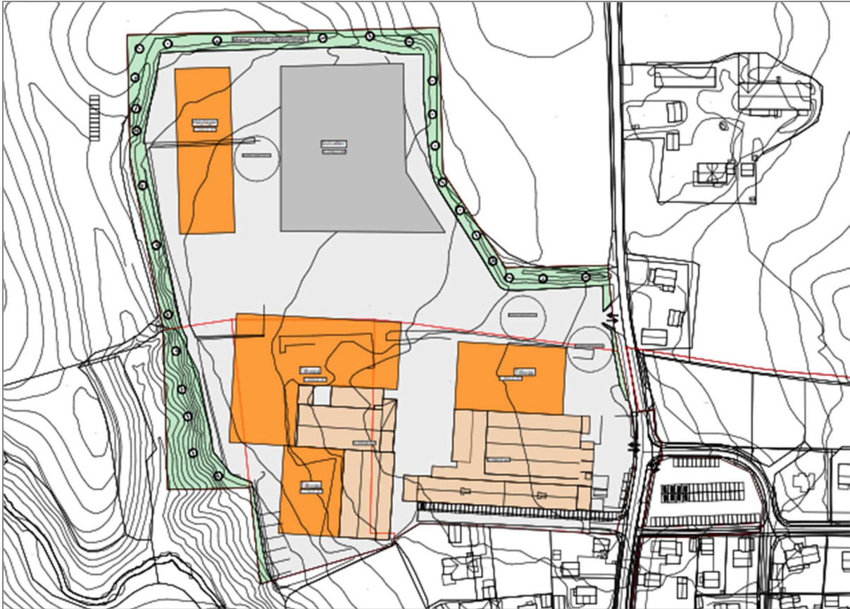
Figur 6 Eksisterende bebyggelse i grå farger. Ny mulig bebyggelse i oransje og tentativt solcelleanlegg i nord-øst (SH Prosjekt AS)
