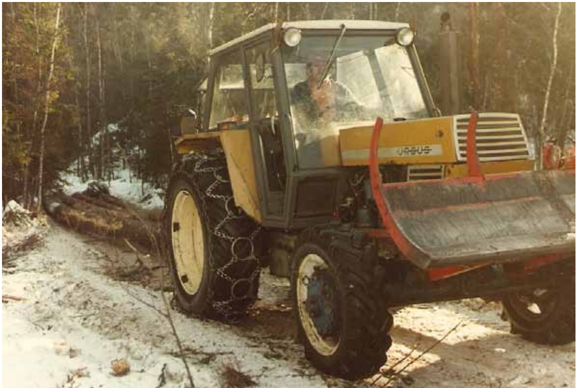
Ved tømmerhogst på 1970- og 80-tallet var det vanlig å utstyre landbrukstraktoren med frontskjær og vinsj til bruk i skogen. Hele stammer ble kjørt frem til velteplassen og kappet og sortert der. Her er August Myrvold på vei fra hogstfeltet ved Grøvikmyra til velta med lass. Foto: Nils Nilssen, 1982.
